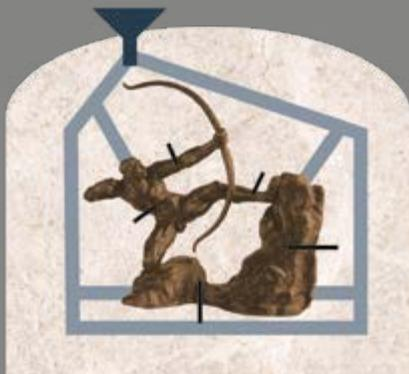
Se coloca una malla metálica con cemento alrededor de todo el conjunto que permita protegerlo al realizar el vaciado del bronce, que se realiza a una temperatura entre los 1100 y 1200° C.
